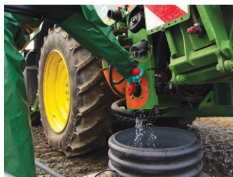
Ouvrir la vanne de vidange. A partir d'un certain niveau de liquide, la pompe se déclenche toute seule
