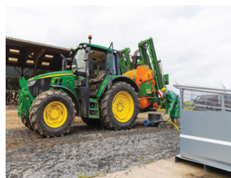
Positionner S-Collect sous la bonde de vidange du pulvérisateur
