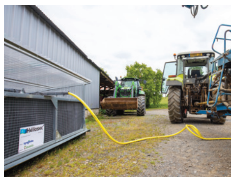
Connecter le tuyau à l'Héliosec
