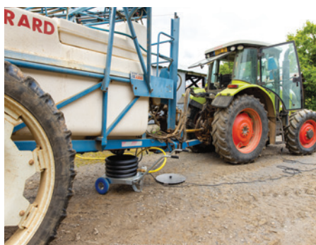
Brancher la prise électrique sur le tracteur
