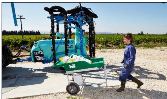
Figure 3 : MobiPhyt Préparer® et MobiPhyt Confort®, deux équipements pour sécuriser le transport et le remplissage du pulvérisateur lors de la préparation des bouillies phytos. (Title : MobiPhyt® equipments to secure mixing loading of the sprayer )
